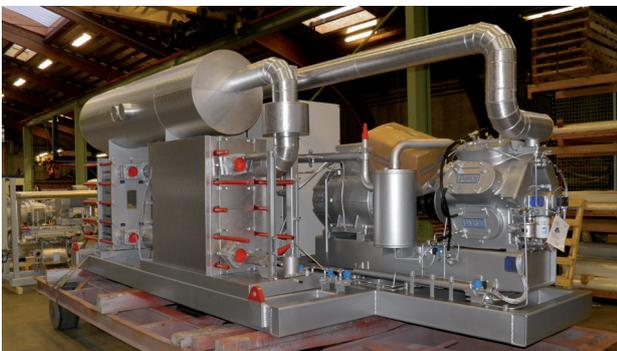
*Die kompakte NH<sub>3</sub>-Wärmepumpe nach dem Testlauf im Werk*
